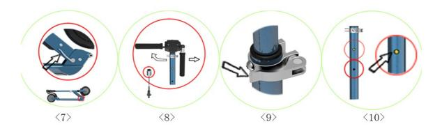
Schwenken Sie den Lenker nach oben bis der Faltmechanismus einrastet <7> Schwenken Sie die Lenkerenden nach oben bis sie einrasten <8> Öffnen Sie die Klemmschelle <9> und stellen Sie die Lenkerhöhe nach Ihrer Körpergröße ein bis der Sperrstift <10> einrastet.
