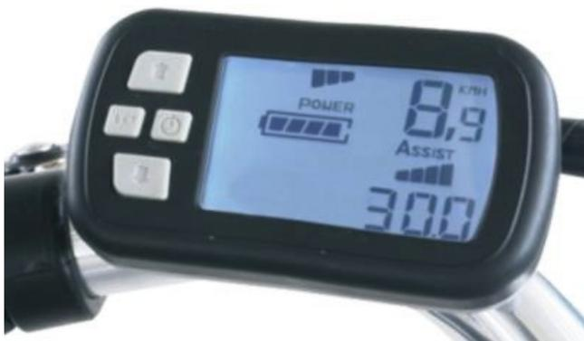
Unsere Umbaukits haben ein LCD Display mit Tachometer, mit diesem LCD Display haben Sie die Möglichkeit mit ASSIST verschiedene Unterstützungsstufen einzustellen, Hintergrundlicht einzuschalten, Ihre Batterie und momentanen Stromverbrauch anzuzeigen, sowie die Geschwindigkeit und Gefahrenen Km (Tages & Gesamt KM) abzulesen.
