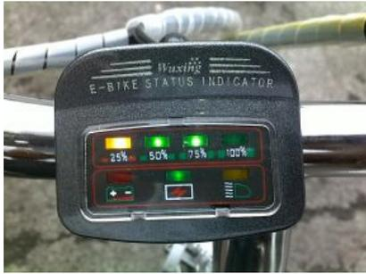
Wenn die Batterie voll geladen ist, leuchten alle vier LEDs, wenn nur mehr eine LED leuchtet müssen Sie die Batterien neu laden bevor Sie das Fahrrad im Batteriebetrieb nutzen.
