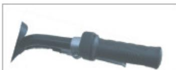
Der Drehgriff dient zur stufenlosen Regelung der Geschwindigkeit. Betätigen Sie den Drehgriff, beginnt sich das Vorder- oder Hinterrad zu drehen. Diese Anfahrhilfe ermöglicht Ihnen ohne treten eine Geschwindigkeit bis zu 25 km/h. Dies ist vor allem beim Anfahren am Berg ein spürbarer Vorteil. Dass der Antrieb unabhängig von der Kraft des Tretens arbeitet, kommt vor allem Personen zugute, die nicht genügend Kraft und Ausdauer haben, oder ihre Gelenke nicht belasten dürfen.
