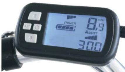
Einige Modelle haben ein LCD Display mit Tachometer, mit diesem LCD Display haben Sie die Möglichkeit 5 verschiedene Stufen einzustellen, Ihre Batterie und Ausgangsleistung anzuzeigen, sowie die Geschwindigkeit abzulesen.
