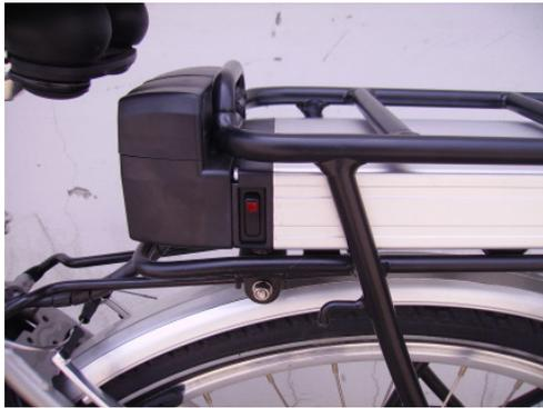
Sollten Sie beim Fahren Aussetzer haben, wurde die Batterie bereits Tiefentladen und Sie haben möglicherweise Batteriezellen beschädigt und Ihre Reichweite zukünftig verkürzt.
