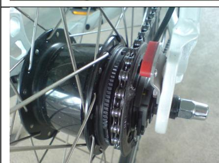
**C) Montagebeispiel des Speed Sensors bei Nabenschaltung am Hinterrad:**
