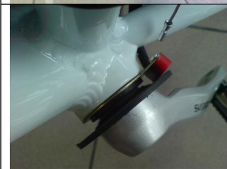
**B) Montagebeispiel des Speed Sensors bei Kettenschaltung an der Tretkurbel:**
