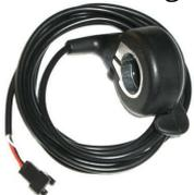
Lenkergriffe entfernen. Ggf. Schalthebel für die Gangschaltung von der rechten auf die linke Seite des Lenkers umbauen. Kabel zum Steuergerät verlegen und anstecken.
