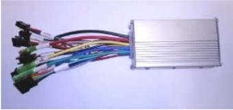
Das Steuergerät wird hinter dem Sattelrohr in einer Tasche oder in einer Box des Akkus verbaut, alle Kabellängen sind dafür ausgelegt um bei normaler Verlegung, hinter den Sattel in Höhe des Gepäckträgers zu kommen. Alle Kabel (Akku, Motor, Tretsensor, Drehgriff und gegebenenfalls die \*Bremshebel) am Steuergerät einstecken.
